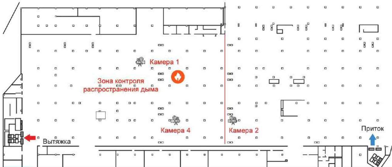
Рисунок Е.1 — Схема ИГД в дымовой зоне 5000 \text{ м}^2 , расположение стационарных видеокамер
